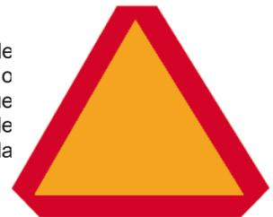
El emblema es un triángulo de color amarillo-naranja fluorescente con una base de 14" y 14" de altura. El triángulo debe tener un borde con rayas rojas reflectantes de uno y tres cuartos de pulgada de ancho y estar montado en el centro de la parte trasera del vehículo a una altura de tres a cinco pies por encima de la calzada.
