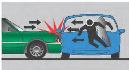
Las bolsas de aire son solo una parte de un sistema de protección total de los ocupantes. Si su vehículo tiene un sistema de cinturones de seguridad de dos piezas, use tanto el cinturón de la cintura como el de hombro. El uso de cualquiera de las dos partes por sí solo reduce en gran medida su protección. Si tiene un cinturón de hombro automático, abrache también el cinturón de cintura. De lo contrario, en una colisión podría salirse del cinturón y resultar herido o muerto.
